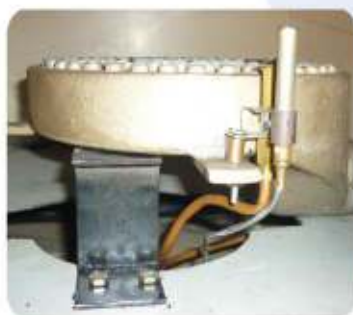
Quemador radial con termopila
