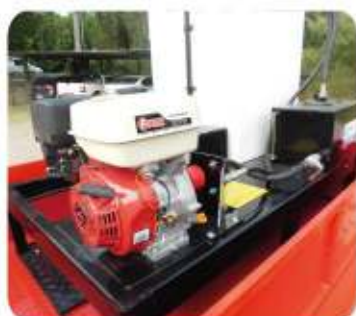
Central hidráulica con motor a explosión
