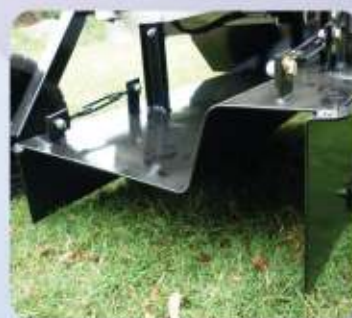
Moldes cambiables con fratacho regulable
